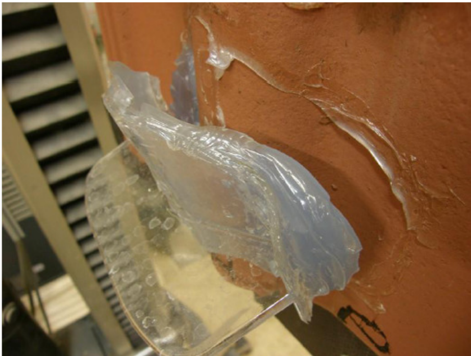
Kulo-lim ( Kulo 1 ) lossna från teglet med en styrka på 3846 N
